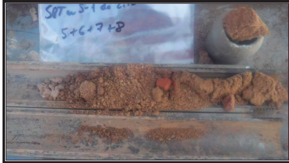
Materials de la capa R, recuperats a l'assaig SPT.
