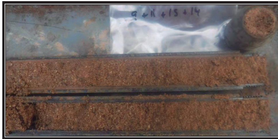
Aspecte dels materials de la capa A, recuperats a un assaig SPT.
