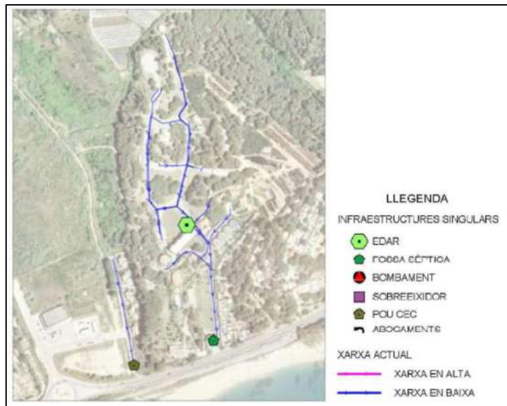
Figura 3: Infraestructures de sanejament de Roques blanques.
