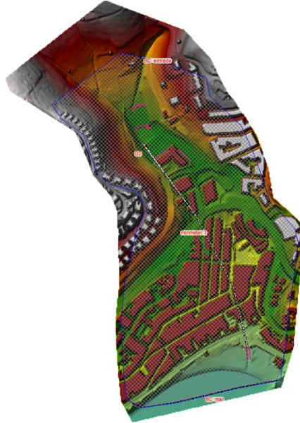
Figura 30. Esquema de la discretització del model hidràulic amb el software HEC-RAS del torrent de l'Arrosser
