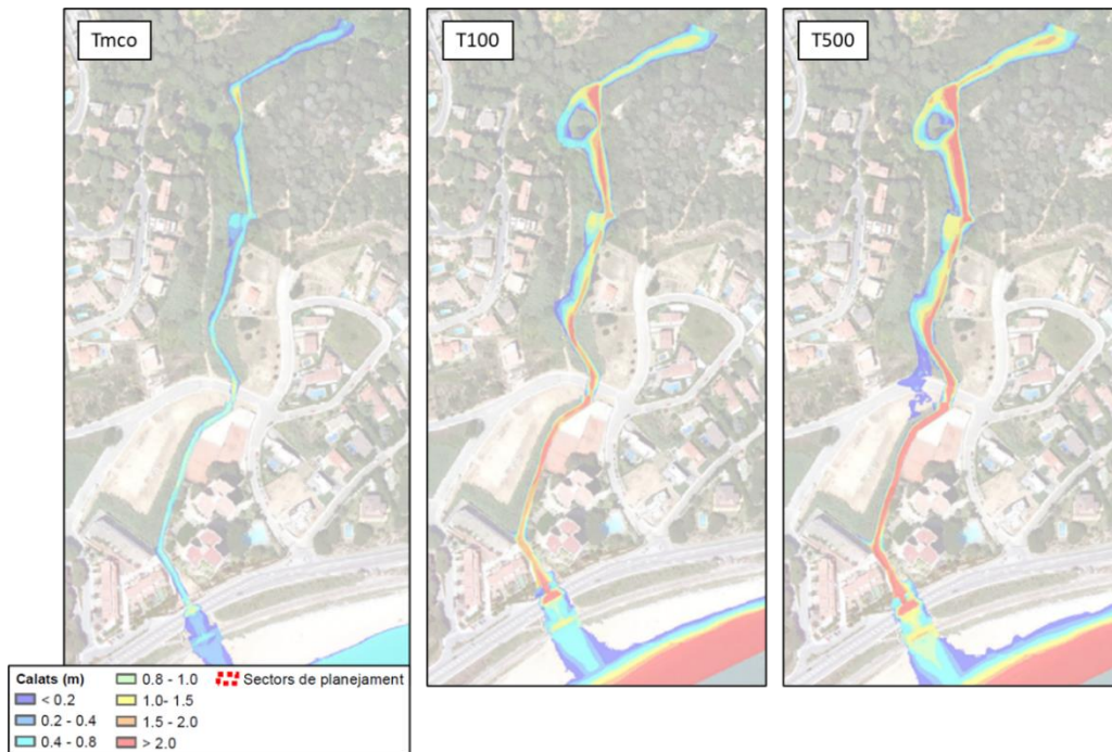
Figura 45. Calats d'inundació per a MCO iavingudes de 100 i 500 anys de període de retorn del torrent de Morer
